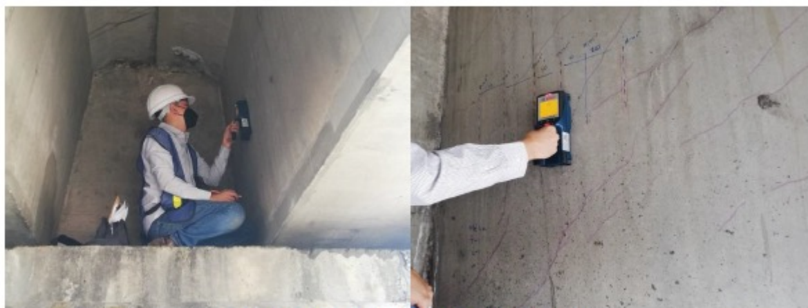
PRUEBA CON ESCÁNER TRABE 01 CLARO 01.
